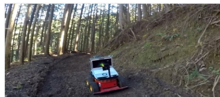
図 3 3次元地図上の位置推定・経路追従システム
